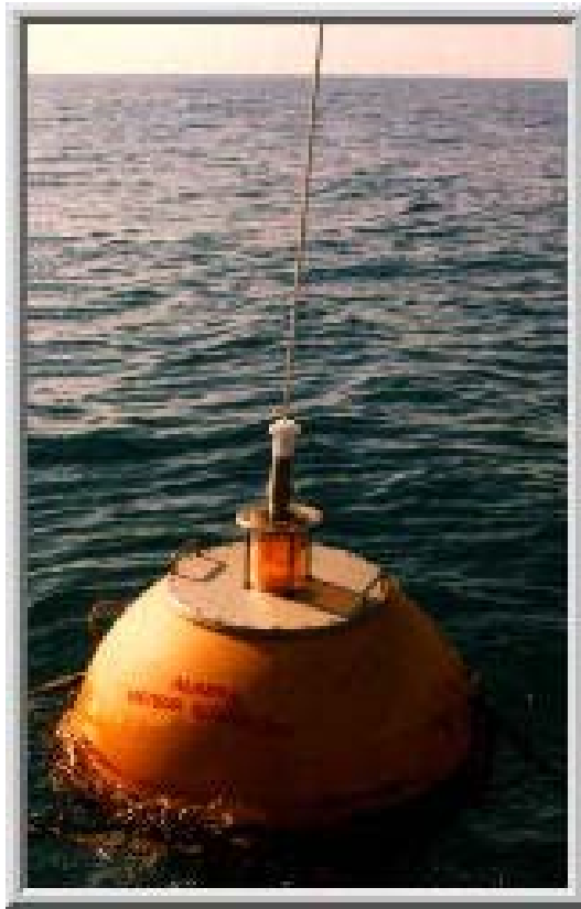
Figura 2.1: Foto de una boya Waverider.
