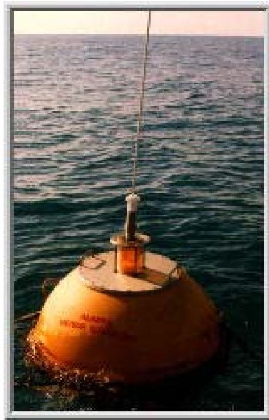
Figura 2.1: Foto de una boya Waverider.
