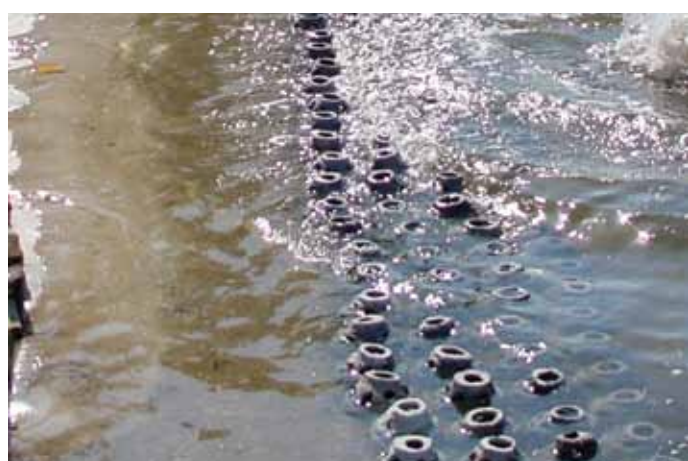
Test in campo – barriera frangiflutti con onde
